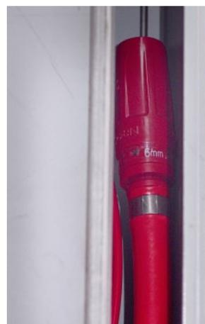
Montage- und Nach-Gebrauchshinweis: Schlauch durch Führung legen, vom Ende so viel überstehen lassen, dass der Schlauch im Notfall leicht zu greifen ist, Schlauch nach oben drücken, Türen langsam schließen
