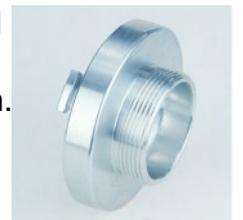
Geeignet zum Einschrauben in Festkupplungen mit metallischer Dichtfläche. Die Abdichtung erfolgt über Flachdichtring. Öffnen und Schließen nur mittels Überflurhydrantenschlüssel möglich.
